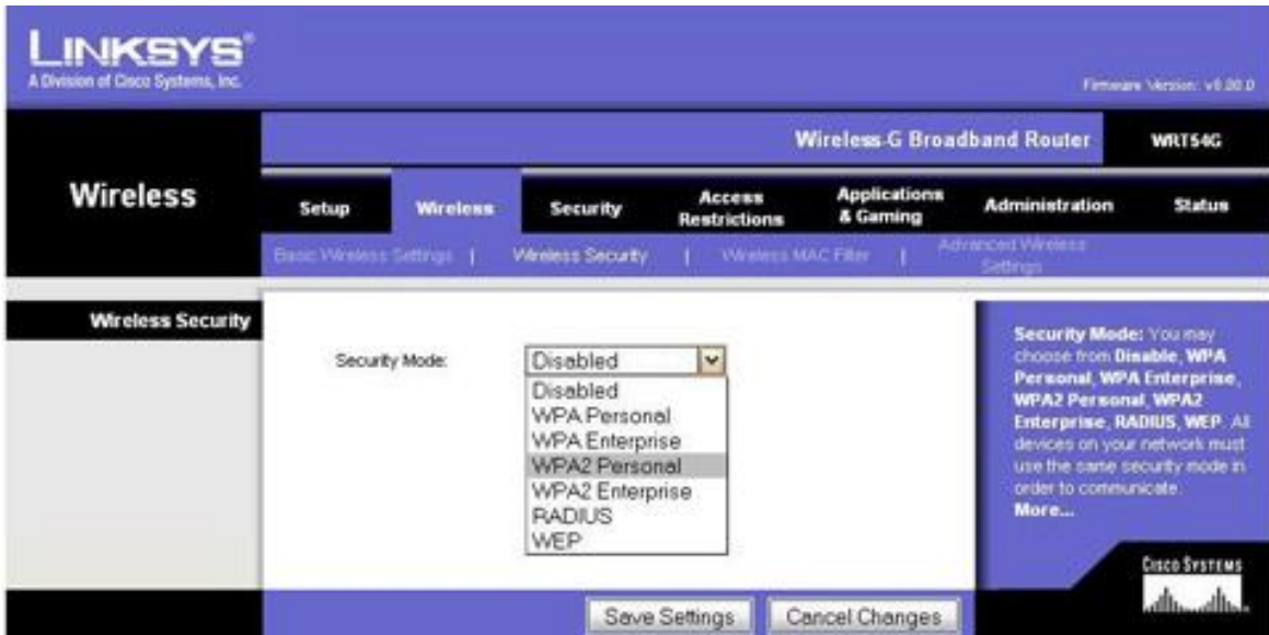
Hình 3.7: Cấu hình WAP2 trên Access Point
