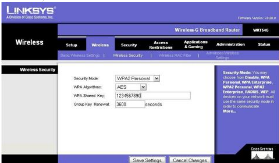
Hình 3.8: Cấu hình WAP2
